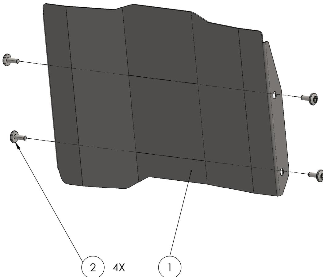
*Die Kühlerabdeckung wird mit dem Original Befestigungsmaterialien angeschraubt. Dabei ist zu beachten, dass das Kühlerabdeckungsblech unter den Halteblechen der seitlichen Kühlerverkleidungen befestigt wird. Anschließend können die seitlichen Kühlerabdeckungen wieder verbaut werden!*
