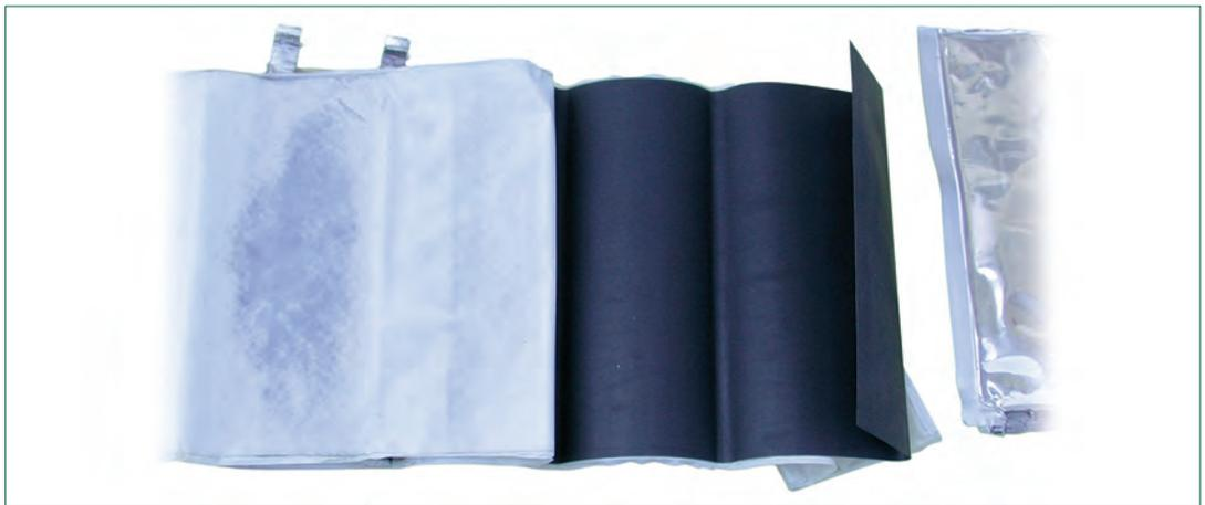
**Bild 1: Abgewickelte Folie einer Li-Ionen-Zelle**
