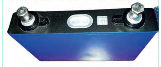
Bild 3: Prismatische Lilon-Großzelle aus chinesischem Labor. Daten:  $C = 30,5 \text{ Ah}$ ,  $R_i = 0,63 \text{ m}\Omega$
