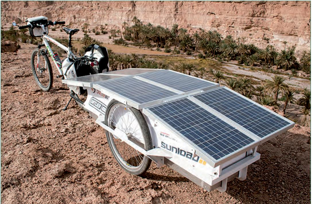
Bild 1: S-Pedelec mit Solarzellen im Anhänger
