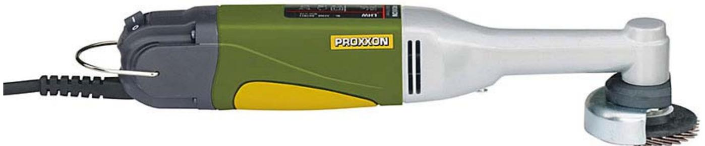
Zum Trennen, Schruppen, Schleifen, Feinschleifen und zur Formgebung in Holz. Balancierter DC-Spezialmotor, durchzugskräftig, leise und langlebig. Stabiler Getriebekopf aus Alu-Druckguss. Hauptgehäuse aus glasfaserverstärktem POLYAMID. Komplett mit Schleifscheibe aus Edelkorund (K 60), Lamellen- Schleifscheibe (K 100) und Trennscheibe (gewebeverstärkt).
