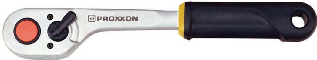
Mit makelloser Verzahnung: Mehrere der 72 Zähne rasten gleichzeitig ein und übertragen ein extremes Drehmoment. Umschalthebel für Rechts- und Linkslauf. Entriegelungs-Mechanismus: Lösen der Einsätze durch Knopfdruck. Kopf und Schaft aus einem Stück CrV-Stahl geschmiedet, 2x vernickelt und matt-verchromt. Griff aus öl- und säurefestem TPR (Thermoplastic Rubber) mit praktischer Bohrung zum Aufhängen.
