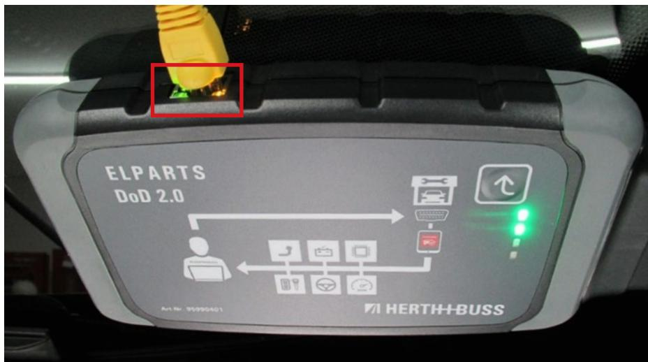
Beide LEDs leuchten dauerhaft. Die VCI ist mit dem Server verbunden und Sie können den DoD-Dienst in Anspruch nehmen. Ein Reset der VCI ist notwendig, wenn diese in ein anderes WLAN-Netz eingebunden werden soll. Die VCI muss über eine OBD-Steckdose mit Spannung versorgt werden.
