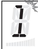
Sobald der 1. Gang erkannt wird, blinkt „-“ kurz auf, bevor automatisch die nächste Ziffer „2“ angezeigt wird.
