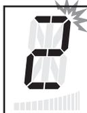
In den 2. Gang schalten und 2.500 ~ 3.500 U/min beibehalten, bis „-“ blinkt, bevor automatisch die nächste Ziffer „3“ angezeigt wird. Auf diese Weise bis zur Einstellung der letzten Ziffer (des höchsten Ganges) fortfahren.
