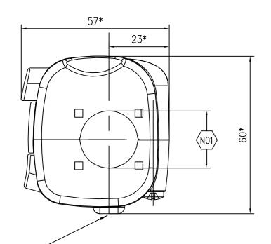
ATTENZIONE: ORIENTARE IL DISPOSITIVO SUL MANUBRIO IN MODO CHE IL FORO DI DRENAGGIO SIA POSIZIONATO VERSO IL BASSO.
