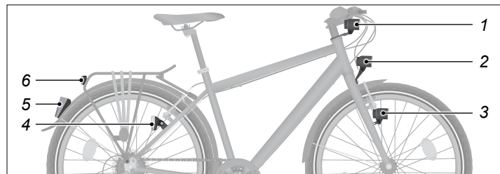
Fig. : Emplacement de montage de l'équipement d'éclairage
