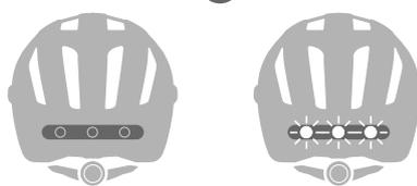
Front- und Rücklichter beginnen schnell pulsierend aufzuleuchten und zeigen an, dass der Pairing-Modus aktiv ist.
