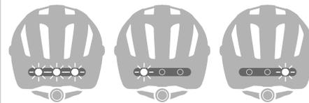
Nach erfolgreicher Kopplung steuert die MODE-Taste der Fernbedienung die verschiedenen Modi der Front und Rücklichter. Die L- und R-Tasten steuern jeweils den linken bzw. rechten Blinker
