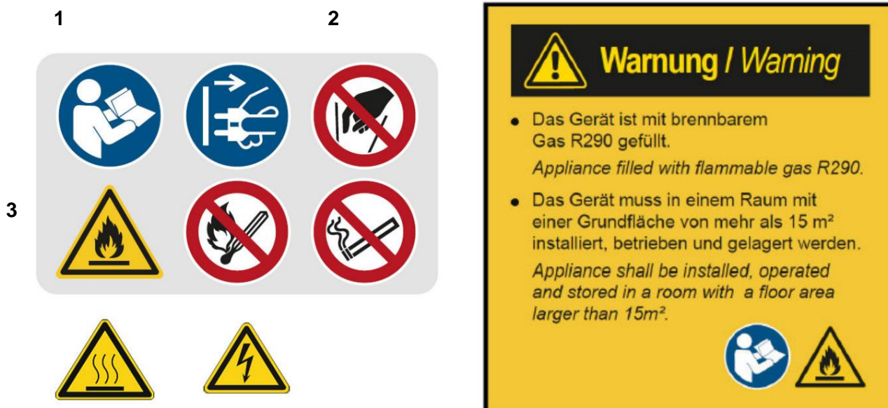
Fig. 1-1: Sikkerhedsmarkeringer: 1 Påbudsskilt: Følg betjeningsvejledningen, tag stikket ud | 2 Forbudsskilt: Ingen indtrængen i apparatet, ingen åben ild; ild, rygning forbudt | 3 Advarselsskilt: Advarsel om brandfarlige stoffer, advarsel om varm overflade, advarsel om elektrisk spænding
