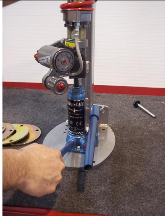
Drücken Sie den Feder bis die Federverriegelung frei zugänglich ist.
