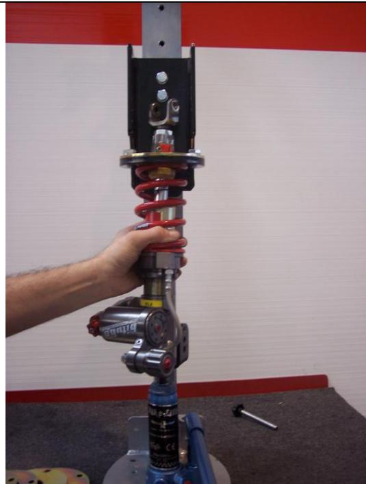
Schließen Sie das Ventil des Hydraulikzylinders zu.
