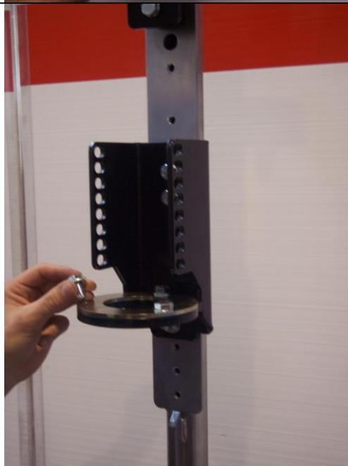
Führen Sie das Federbein ein und stellen Sie die Höhe der unteren Stütze nach der Länge des Federbeins ein. Halten Sie das Federbein anhand des jeweiligen Stiftes.
