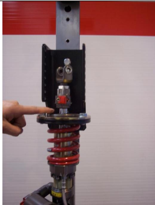
Nehmen Sie die Federverriegelung weg und lassen Sie den Feder frei indem Sie den Hydraulikzylinder durch den jeweiligen Hebel entlüften
