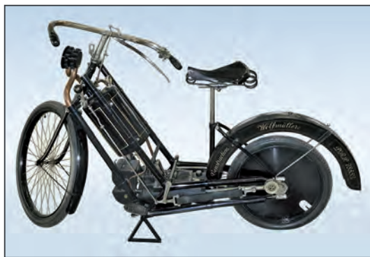
Bild 3: Das Hildebrand- und Wolfmüller-Motorrad mit Glühzündung
