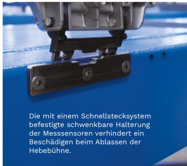
Die mit einem Schnellstecksystem befestigte schwenkbare Halterung der Messsensoren verhindert ein Beschädigen beim Ablassen der Hebebühne.
