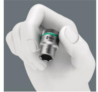
Die Zyklus Nüsse sind für die Hand- und Maschinenbetätigung (non impact) geeignet. Sie sind mit Kugelfangrille und Rändelung am hinteren Ende für hohe Griffbarkeit bei der Handbetätigung ausgestattet. Gefertigt sind sie aus Chrom-Vanadium, mattverchromt. Take it easy Werkzeugfinder: Mit Farbkennzeichnung nach Größen sowie Größenstempelung - zum einfachen und schnellen Finden der gewünschten Nuss.
