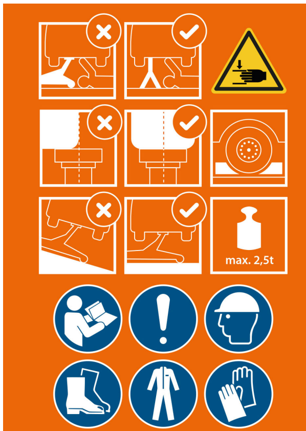
Abb. 1: Sicherheitskennzeichnung SRWH 2501 EF - 1 Sicherheitshinweise | 2 Warnzeichen: Warnung vor Handverletzungen | 3 Gebotszeichen: Anleitung beachten, allgemeines Gebotszeichen, Kopfschutz benutzen, Fußschutz benutzen, Schutzkleidung benutzen, Handschutz benutzen
