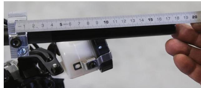
Bestimmen Sie die Position der Bohrungen in Umfangsrichtung entsprechend der später gewünschten oder empfohlenen Stellung der Bedienelemente.
