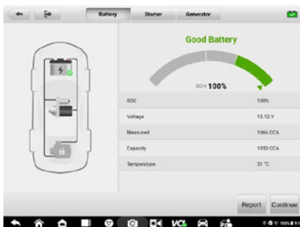
Figura 9-6 Schermata con i risultati del test della batteria
