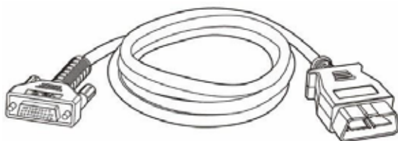
Figure 2-5 Câble principal V2.0 - longueur 1,5 m
