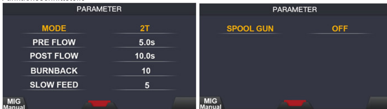
Abb.5-13: Funktionsschnittstelle MIG (Manuell)
