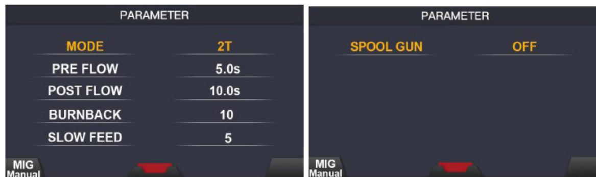
Abb.5-24: Funktionsschnittstelle MIG (manuell)
