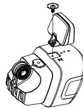
Der Reflektor wird von unten am Lampengehäuse verschraubt.
