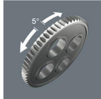
Die Feinverzahnung mit 72 Zähnen ermöglicht einen kleinen Rückholwinkel von nur 5° für Arbeiten in begrenzten Verschraubungssituationen.
