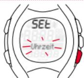
Taste SET drücken. „24H“ wird angezeigt und blinkt. Mit der Taste SPEED (+) oder PULSE (-) wählen Sie zwischen einer 12-Stunden- oder 24-Stundenanzeige.
