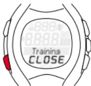
Taste PULSE (-) lang drücken. Sie wechseln in den Ruhemodus. Sie sehen nur die Uhrzeit und das Datum und sparen Batterie. Die aktuellen Trainingswerte bleiben gespeichert.
