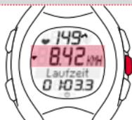
Mit der Taste SET wechseln Sie in der mittleren Zeile zwischen Geschwindigkeit und Strecke.
