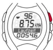
6. Wenn Sie das Training beenden wollen, drücken Sie die Taste START/STOP. Die Stoppuhr steht. Um die Werte auf Null zurückzusetzen, drücken Sie die Taste START/STOP lang. Um den Trainingsmodus zu verlassen, halten Sie die Taste PULSE (-) lang gedrückt. Genaue Beschreibungen zu den fünf Schritten finden Sie auf den folgenden Seiten.
