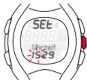
Taste SPEED (+) drücken. Eine Stunde wird hochgezählt. Mit der Taste PULSE (-) würde die Anzeige um eine Stunde runtergezählt.
