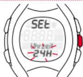
Taste SET drücken. Die Uhrzeit wird angezeigt. Die Stundeneingabe blinkt.
