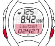
Mit den Tasten PULSE (-) oder SPEED (+) wählen Sie aus, welche Funktion Sie im unteren Anzeigebereich sehen möchten.
