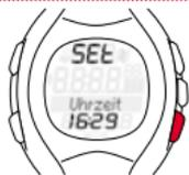
Taste SET drücken, die Minuteneingabe blinkt, und kann jetzt mit den Tasten PULSE (-) oder SPEED (+) eingestellt werden.
