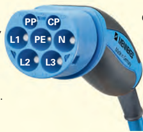
Bild 1: Kontaktbelegung des Typ 2-Ladesteckers
