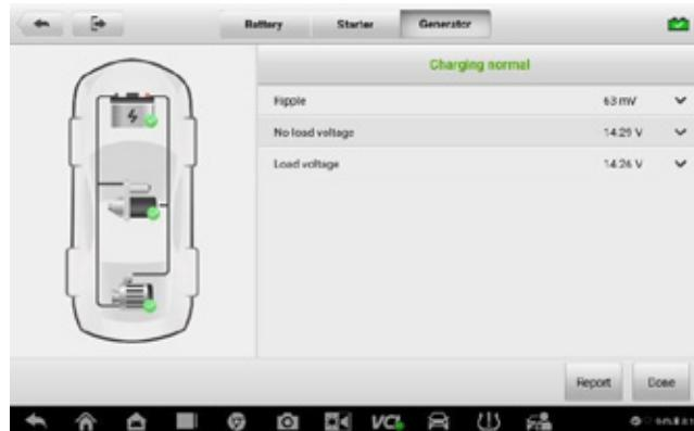
Abbildung 9-12 Bildschirm mit den Testergebnissen des Generators
