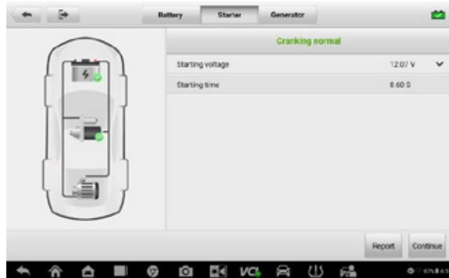
**Abbildung 9-10 Bildschirm mit den Ergebnissen des Startertests**
