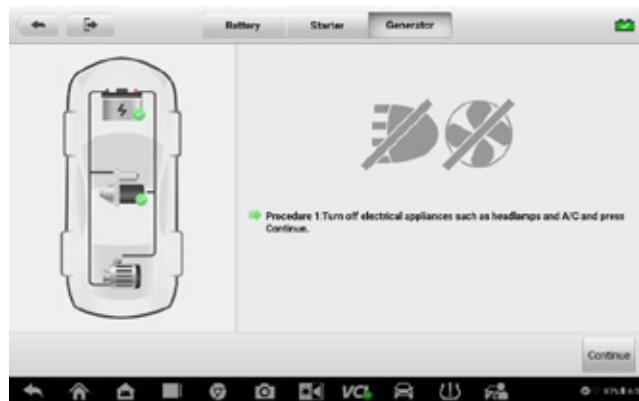
Abbildung 9-11 Bildschirm Generator-Test
