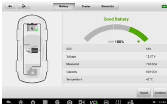
***Abbildung 9-7 Bildschirm mit den Ergebnissen des Batterietests***
