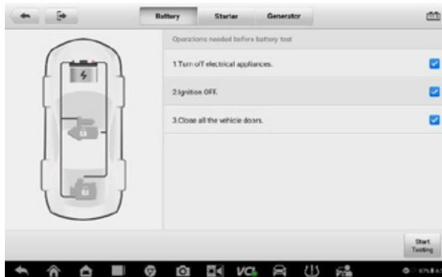
**Abbildung 9-6 Bildschirm "Batterietest"**
