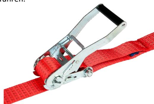
6. Durch öffnen und schließen der Ratsche das Gurtband bis zu einer Handkraft von max. 50 daN vorspannen.
