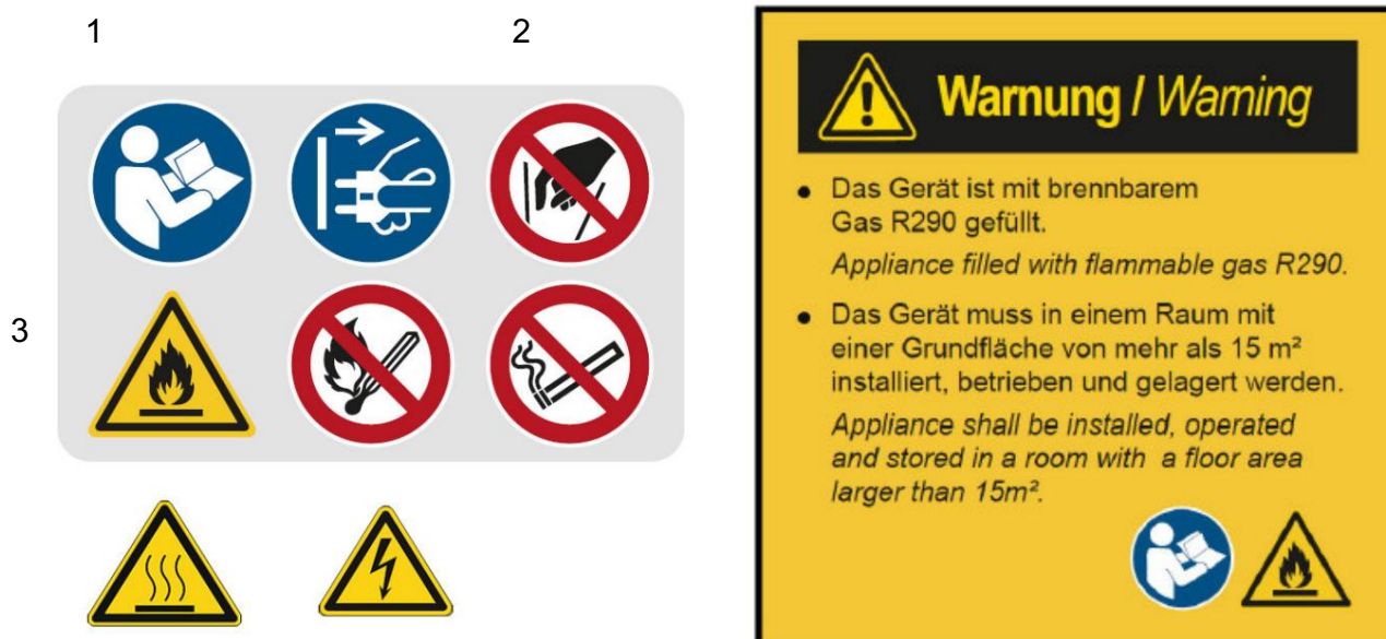
Fig. 1-1: Señales de seguridad: 1 Señal de obligación: Observe las instrucciones de uso, desenchufe el cable de alimentación | 2 Señal de prohibición: No introducir las manos en el interior, no se permite el paso a llamas abiertas; fuego, prohibido fumar | 3 Señal de advertencia: Advertencia sobre sustancias inflamables, advertencia sobre superficies calientes, advertencia sobre tensión eléctrica
