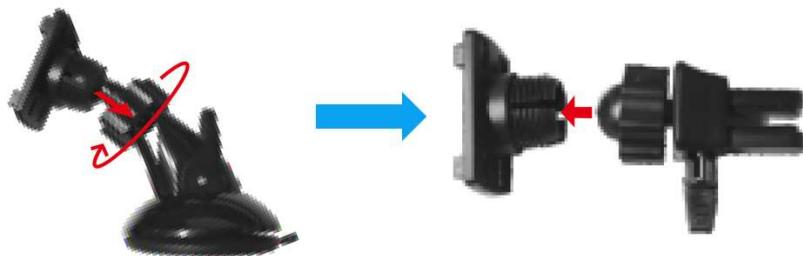
Drehen Sie nun die Rändelmutter wieder auf die Halteplatte und ziehen Sie sie handfest an. Der Klemmhebel der Halterung sollte dabei nach oben zeigen.
