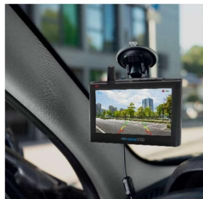
Lösen Sie die Rändelmutter am Halter auf der Monitorseite (Kugelkopf), stellen den Monitor in eine für den Fahrer gut sichtbare Position, halten ihn in dieser fest und ziehen die Rändelmutter wieder handfest an, um den Kugelkopf zu fixieren.
