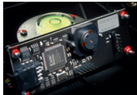
CMOS-Kamera mit hoher Auflösung und Bildrate
