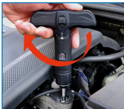
Drehen Sie den Drehmomentschlüssel im Uhrzeigersinn und stoppen Sie direkt nach einem „click“ Geräusch.
