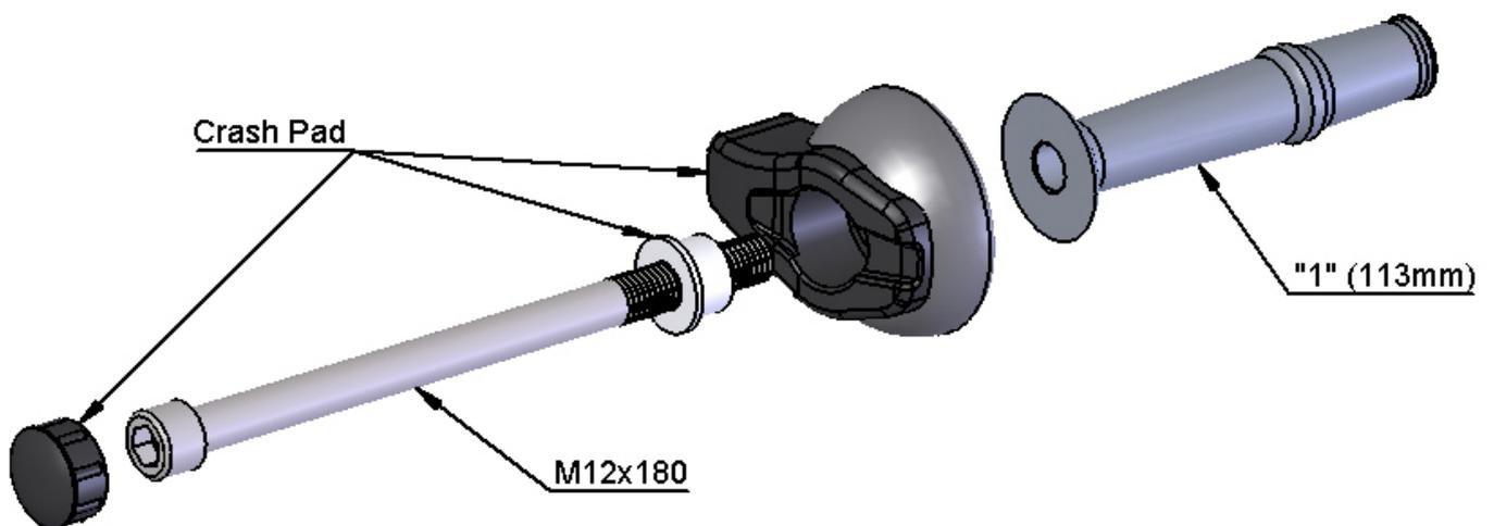
**Montage links / Fitting left side / Montage côté gauche:**
