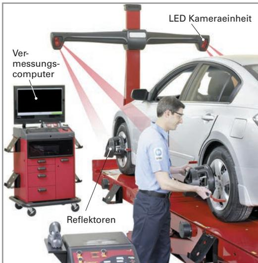
Bild 1: Aufbau 3D-Achsvermessung
