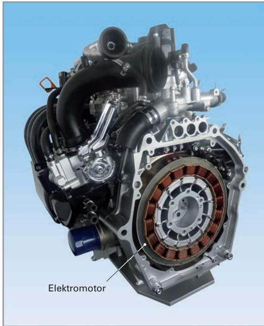
**Bild 1: Paralleles Hybrid-System**
