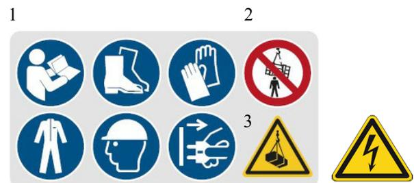
Abb. 2: Sicherheitskennzeichnungen - 1 Gebotszeichen: Anleitung beachten, Fußschutz benutzen, Handschutz benutzen, Schutzkleidung benutzen, Kopfschutz benutzen, Netzstecker ziehen | 2 Verbotsschilder: Nicht unter angehobene Last treten | 3 Warnzeichen: Warnung vor schwebender Last, Warnung vor elektrischer Spannung
