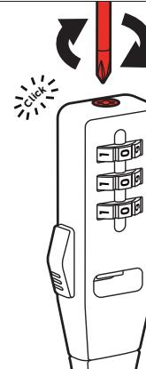
**2** Schraube im Uhrzeigersinn drehen, bis sie nach unten drückt (Verwenden Sie einen Kreuzschlitzschraubendreher)
