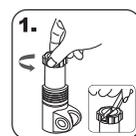
Vorbaukappe losdrehen und abnehmen. Hebel zu Hilfe nehmen, falls die Vorbaukappe zu fest sitzt.
