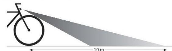
Lösen Sie die Einstellschraube ⑤ und richten Sie den LED-Scheinwerfer so aus, dass der Lichtkegel bis ca. 10 Meter vor dem Rad auf die Fahrbahn reicht (siehe Abbildung).
