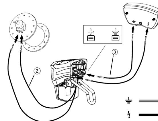
An der Unterseite des LED-Scheinwerfers befindet sich ein Kabelpaar ② zum Anschluss an den Dynamo. Das Kabelpaar kann bei Bedarf zugeschnitten werden. Die in dem LED-Scheinwerfer eingebauten Stecker sind für den Anschluss an die bestehende Verkabelung des Rücklichtes bestimmt. Wenn keine Verkabelung vom Rücklicht vorhanden ist, muss diese hergestellt werden (Verlängerungskabel sind im Fachhandel erhältlich).
