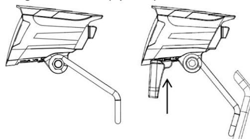
An der Unterseite des Scheinwerfers kann ein weißer Rückstrahler montiert werden.
