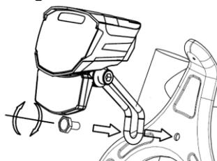
Positionieren und Befestigen Sie den Haltebügel des LED-Scheinwerfers ⑥ an der gewünschten Stelle am Fahrrad. Achten Sie darauf, dass der LED-Scheinwerfer sich nicht von allein wieder verstellen kann. Der Lichtkegel des LED-Scheinwerfers muss immer in Fahrtrichtung geradeaus zeigen und darf andere Verkehrsteilnehmer nicht blenden.
