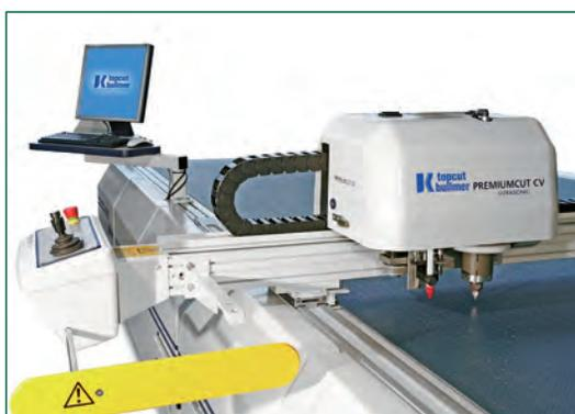
**Bild 3: CNC Ultraschall-Cutter für Prepregs (Topcut-Bullmer)**
