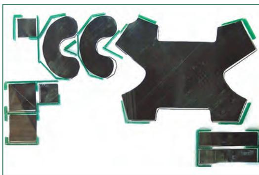
**Bild 2: Prepregs-Einzelzuschnitte**
