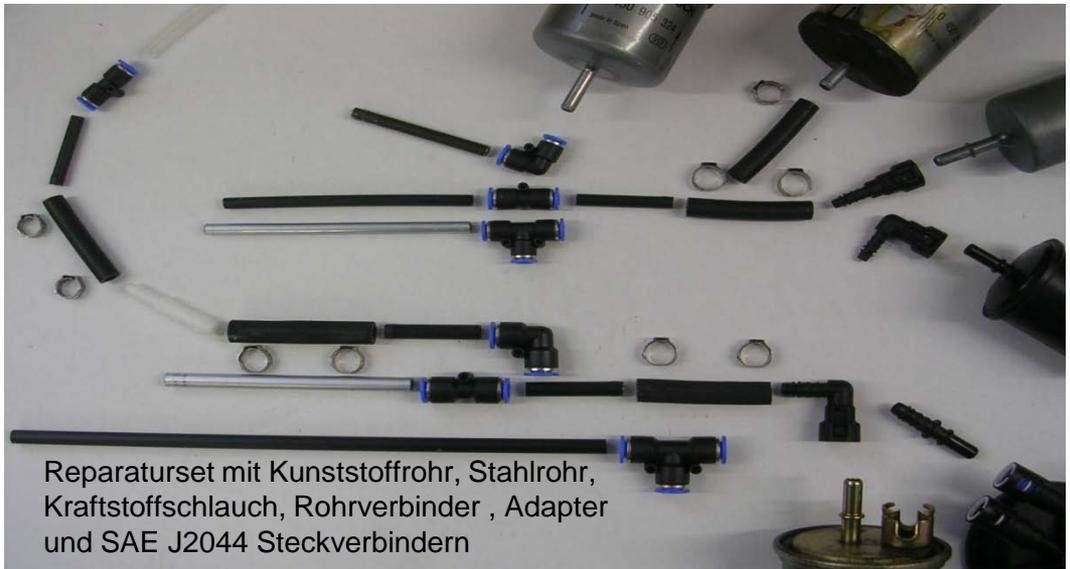
Reparaturset mit Kunststoffrohr, Stahlrohr, Kraftstoffschlauch, Rohrverbinder, Adapter und SAE J2044 Steckverbindern
