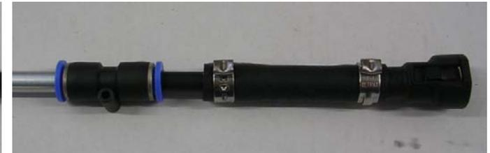
**Speziallösung:** In manchen Filterdeckeln ist der SAE J2044 Stecker integriert. Hierzu müssen Sie den passenden beiliegenden SAE Doppelstutzen montieren. Teilweise kommt die Klammer mit aus dem Deckel, die dann auf den Doppelstutzen montiert und in den Filterdeckel eingeschoben wird. Durch Gegeziehen prüft man den perfekten Sitz der Verbindung
