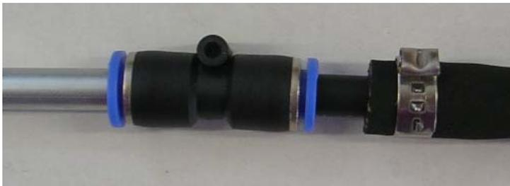
Die Schelle sitzt immer hinter der Sicke um das Abrutschen des Schlauches bei Systemdruck zu verhindern
