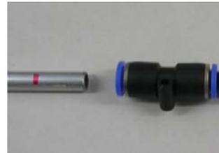
Rohrverbinder mit weiterführendem Stahl- oder Kunststoffrohr verbinden. Durch Eindrücken des blauen Halteringes lässt sich die Kupplung wieder vom Rohr demontieren
