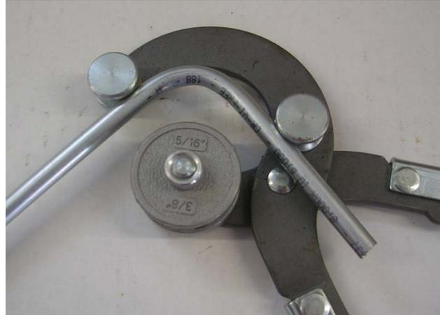
Kunststoffrohre biegen ist eine Spezialtechnik und mit diesem Reparatursatz nicht möglich. Vorsicht: Die Rohre können einknicken. Winkel werden mit den 90 Rohrverbindern realisiert.
