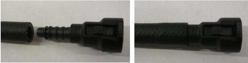
Passende Einrohrklemme montieren, Ohr zudrücken bis Schlauchverpressung sichtbar
