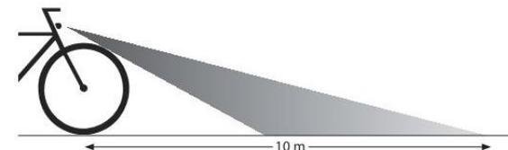
Lösen Sie die Einstellschraube ③ und richten Sie den LED-Scheinwerfer ① so aus, dass der Lichtkegel bis ca. 10 Meter vor dem Rad auf die Fahrbahn reicht (siehe Abbildung).
