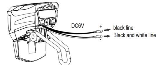
An der Unterseite des LED-Scheinwerfers ① befindet sich ein Kabelpaar ② zum Anschluss an das E-Bike System. Das Kabelpaar ist mit Universal Crimp-Steckern versehen.
