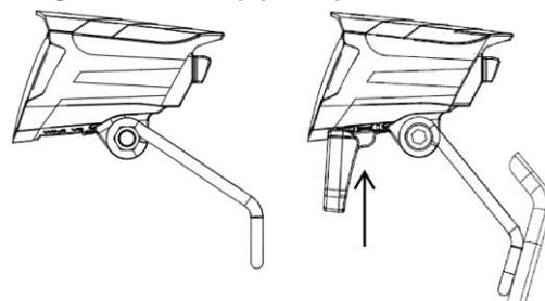
An der Unterseite des LED-Scheinwerfers kann ein weißer Rückstrahler ⑤ montiert werden.
