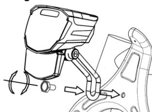
Positionieren und Befestigen Sie den Haltebügel ④ des LED-Scheinwerfers ① an der gewünschten Stelle am E-Bike Fahrrad. Achten Sie darauf, dass der LED-Scheinwerfer ① sich nicht von allein wieder verstellen kann. Der Lichtkegel des LED-Scheinwerfers ① muss immer in Fahrtrichtung geradeaus zeigen und darf andere Verkehrsteilnehmer nicht blenden.
