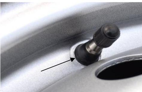
6. Ventilsitz und Dichtungslippe
