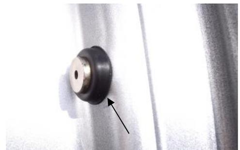
5. Ventilsitz und Anlagefläche kontrollieren
