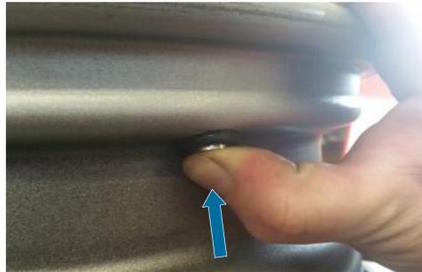
4. Ventil mit Daumendruck oder mit Einziehhebel 071900 in vertikaler Richtung montieren !
