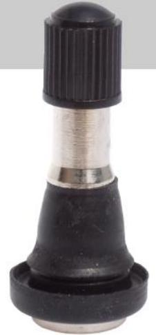
Das Hochdruckgummiventil ist für Transporter und Wohnmobile, die mit einem Reifendruck von mehr als 5,5 bar gefüllt werden. Die Ventile haben ein , bis in den Gummifuß durchgehendes Stützrohr aus Messing mit einer integrierten Sicherheitsstützplatte unter dem Ventilfuß. Das Ventil ist einsetzbar bis zu einer maximalen Materialstärke der Felge von 3,0 mm.
