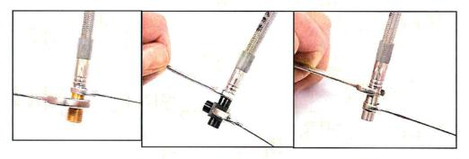
einen Gabelschlüssel wählen, der an die Schlüsselfläche des Anschlusses passt. Am Sechskant des Gewindenippels mit einem 8mm Gabelschlüssel ansetzen und die Verschraubung um 60° anziehen.
