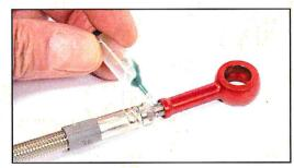
• Fitting handfest auf den Gewindenippel der Stahlflexleitung aufschrauben bis der Fitting am Konus des Gewindenippels anliegt.
