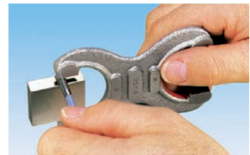
Bild 4: Prüfen von Rachenlehren mit Endmaß und Prüfstift
