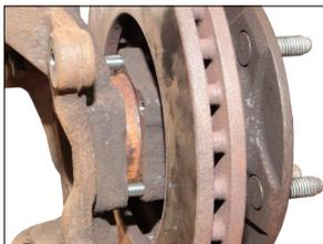
8. Die Radlager-Nabeinheit ist ausgepresst, Inbusschrauben entfernen...
