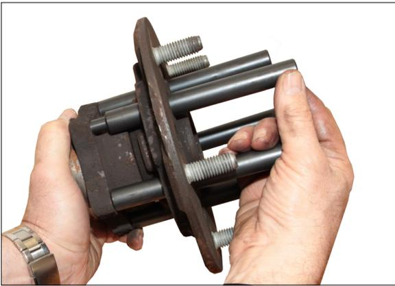
10. Um das Radlager von der Nabe zu trennen, werden die Bolzen durch die Nabe in die Radlagerbefestigungsbohrungen eingesetzt...
