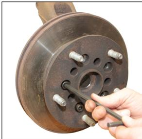
1. Bremscheibenbefestigungsschrauben entfernen...
