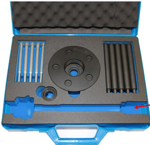
Das Werkzeug-Set wird im Kunststoffkoffer mit Schaumstoffeinlage geliefert. In der Schaumstoffeinlage ist ein Fach für den optionalen Spindeltrieb K 300-130 vorgesehen.
