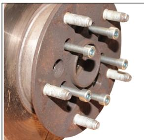
5. Die Inbusschrauben auf gleiche Länge in die Radlagerbefestigung schrauben...
