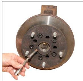
2. Radlagerbefestigungsschrauben entfernen...
