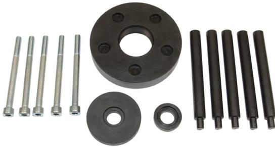
Beim Ford Transit müssen die Radlager-Nabeinheiten ausgebaut werden um die Bremscheiben zu wechseln, da diese hinter dem Radflansch befestigt sind. Mit diesem Werkzeug können alle Arbeiten direkt am Fahrzeug durchgeführt werden. Die Montageart ermöglicht es, die Radlager-Nabeinheiten auszuziehen, ohne dass diese beschädigt werden.
