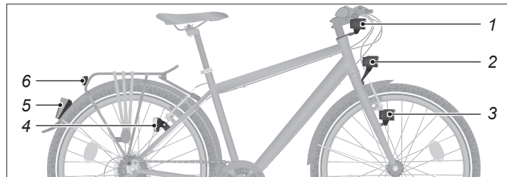
Abb.: Montageorte der Beleuchtungsausstattung
