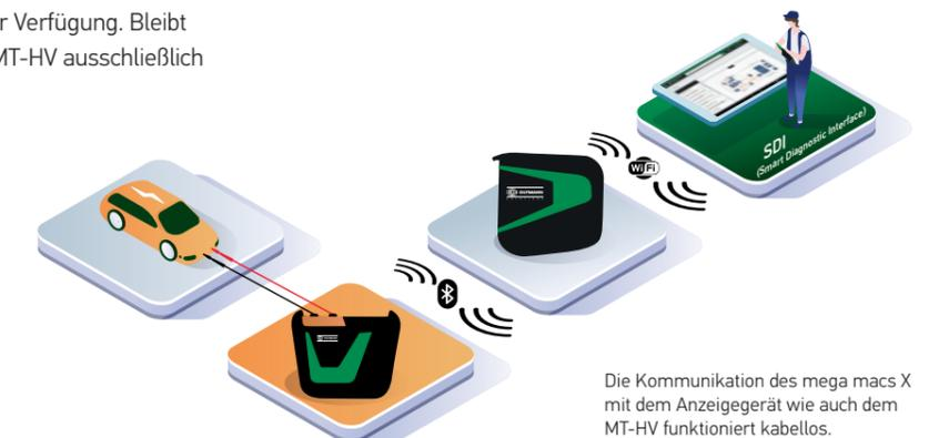
Die Kommunikation des mega macs X mit dem Anzeigegerät wie auch dem MT-HV funktioniert kabellos.
