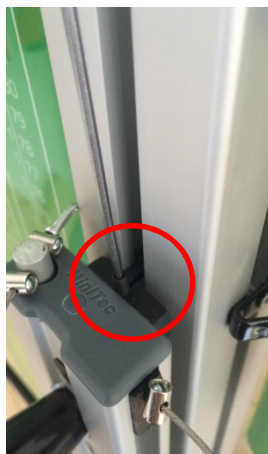
Wurmschraube am oberen Messschlitten einschrauben
