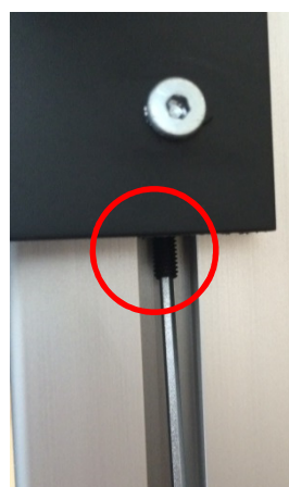
Wurmschraube an der Seitenplatte unten einschrauben
