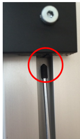
Wurmschraube an der Seitenplatte unten ansetzen
