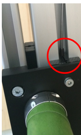
Wurmschraube an der Seitenplatte oben einschrauben
