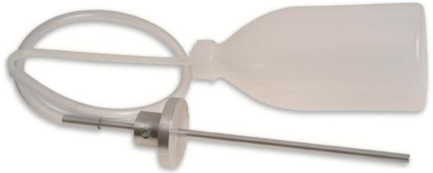
Nun können beide Holme mit frischem Öl befüllt werden. Um das System zu entlüften, sollte die Gabel wieder mehrmals eingefedert werden. Die Füllhöhe des Gabelöls bestimmt die Höhe des darüber liegenden Luftpolsters, welches Einfluss auf die Dämpfungseigenschaften hat (je dickflüssiger und damit je höher der SAE-Wert, desto höher die Ausfeder-(Zugstufen-) Dämpfung, desto träger also das Ausfedern).
