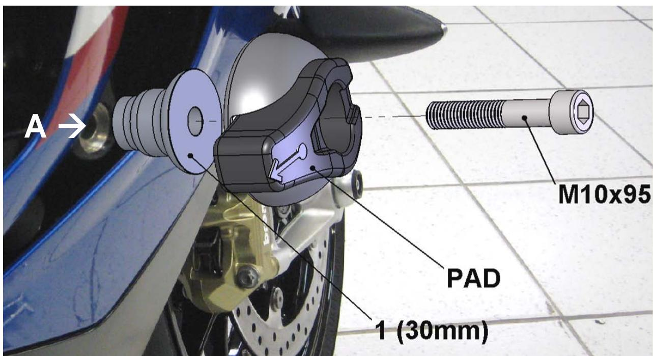
**Montage links / Fitting left side / Montage côté gauche:**
