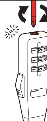
**2** Schraube im Uhrzeigersinn drehen, bis sie nach unten drückt (Verwenden Sie einen Kreuzschlitzschraubendreher)
