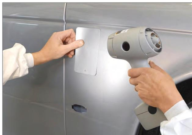
Bild 1: Handlampen mit tageslichtähnlichem Licht
