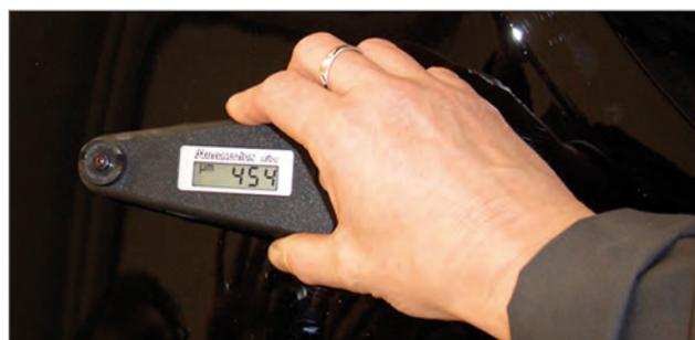
Bild 2: Schichtdickenmessung
