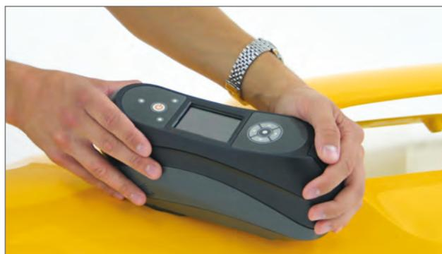
Bild 3: Farbtonanalysegerät
